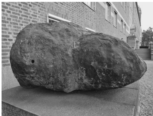
第16図 スウェーデン自然歴史博物館の巨大な自然鉄塊 丸い穴は試料採取の跡。中央付近にスケールとして 10 cmの金尺が置いてある
