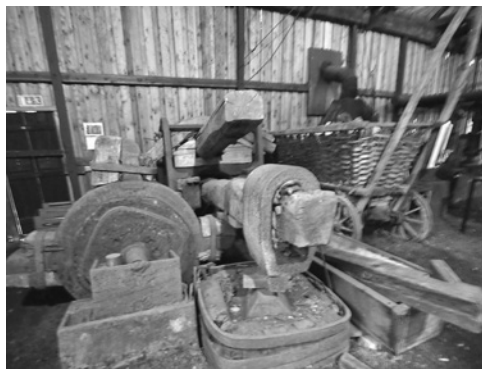
第11図 Orrefors の鍛造用ハンマー
